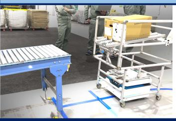
KeiganALIは、お客様の様々な機器を搭載することを想定しています。本体天面には複数のネジ穴により、アルミフレームなどを簡単に取付可能です。24V・5Vの電源取り出し、動力遮断スイッチ、GPIO、LANポート、Wifiをお使い頂けます。
