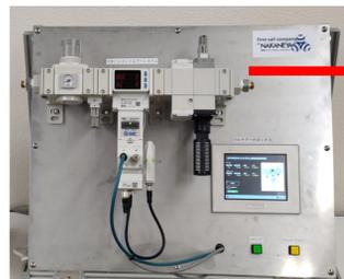
設備停止 → 流量低下検出 → 減圧 + エア遮断
